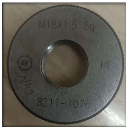
Рис. 4. Непроходной кольцевой калибр
